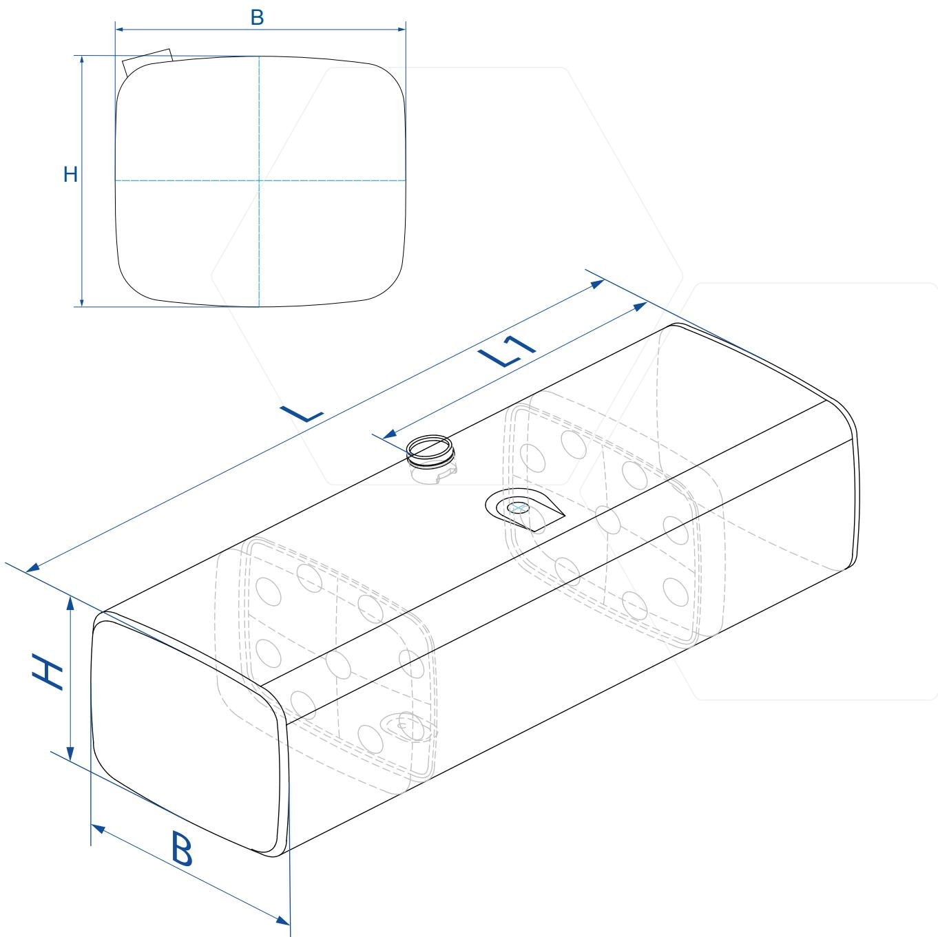
**TANK QUERSCHNITT 640 X 560 STAHL**
